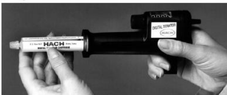
Hình 2: Lắp ống cartridge vào vị trí
