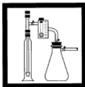
7. Nối hệ thống chân không với thiết bị sục khí, đảm bảo rằng dòng không khí được duy trì (kiểm tra lưu lượng kế) và không khí thổi từ ống thistle và thiết bị sục khí.
