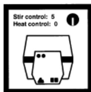
8. Bật công tắc điện và cài đặt điều khiển khuấy đến mức 5.
